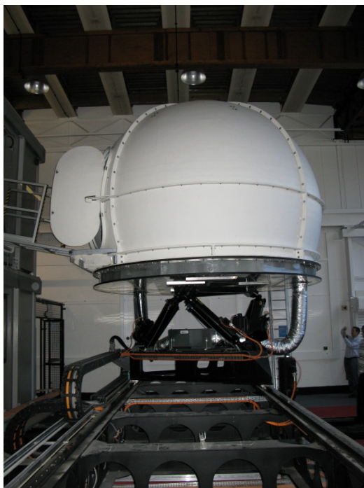
Figur 3 Rörelsesystem och dome för simulatoren i Leeds. Bilden visar relativt liten marginal mot den tillgängliga takhöjden på 7,5–8 meter.
